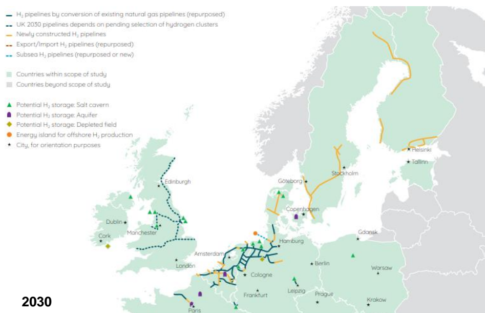
Figur 3-3. Möjlig lösning för vätgasinfrastruktur i norra Europa år 2030 ("European Hydrogen Backbone"). Bilden beskuren för läsbarhet. Rapporten innehåller även möjliga lösningar för 2035 och 2040, se 2040 nedan. Källa: Gas for Climate: a path to 2050, 2021 17
