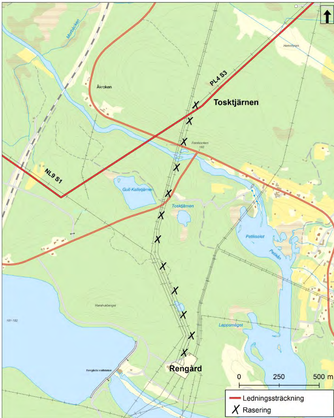
Figur 3. En delsträcka av ledningen PL4 S3 kommer raseras mellan Tosktjärnen och station Rengård. Ledningsgatan lämnas tom och återgår till markägarens försorg.
