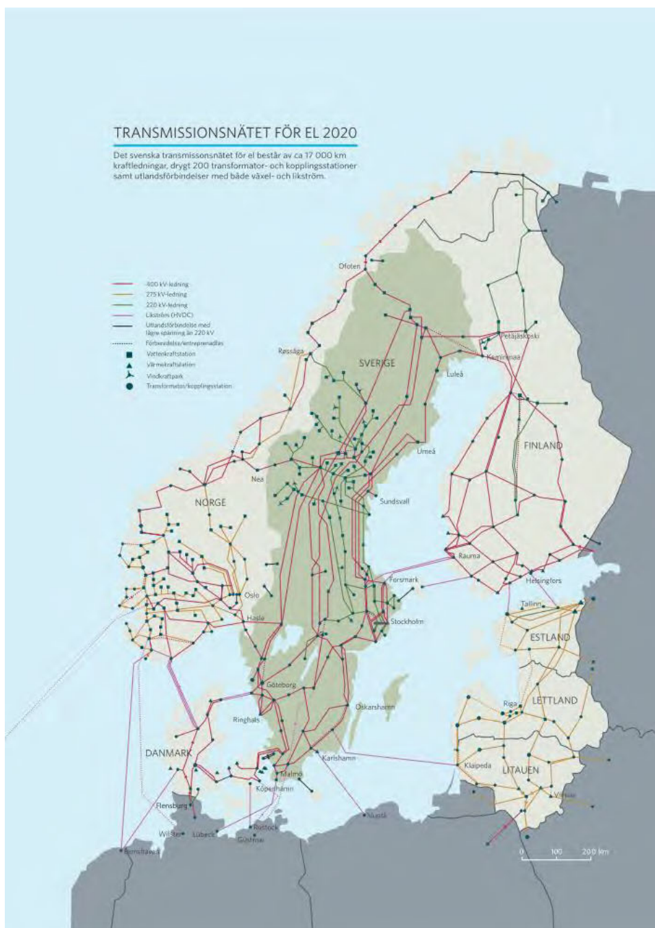
Figur 6. Det svenska transmissionsnätet med utlandsförbindelser och transmissionsnätet i de nordiska grannländerna och Baltikum.
