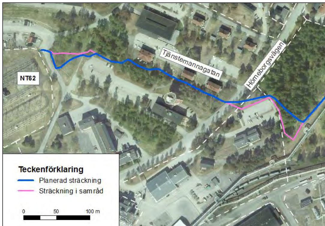
Figur 1. Det rosa strecket visar den tidigare sträckningen och det blå strecket visar den justerade sträckningen efter samråd med ansvariga för nya fjärrkyleledningen.
