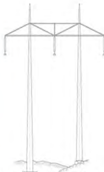
Figur 5. Exempel på ostagad portalstolpe (B-stolpe) och illustration av portalstolpe till höger som planeras mellan Måby och Skoby.
