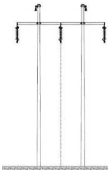
Figur 10. Skiss av portalstolpe med stolpben av trä eller komposit. Normal höjd 15-20 meter.
