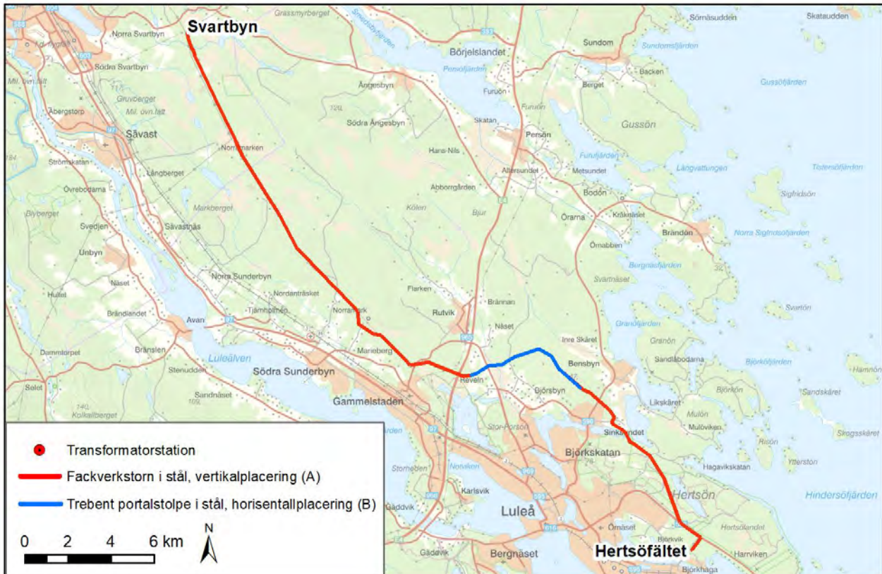
Figur 5. Karta som visar på vilka sträckningsavsnitt respektive stolptyp kommer att användas.
