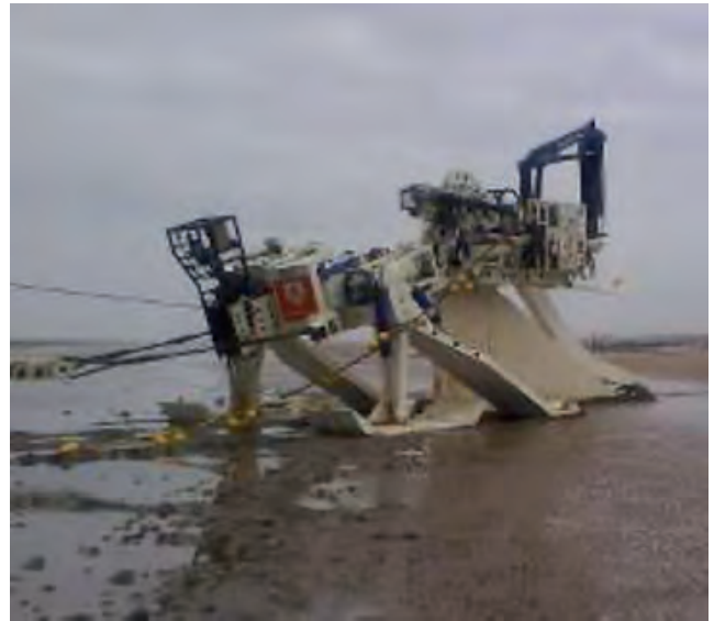
Figur 2.26 Exempel på plog.
