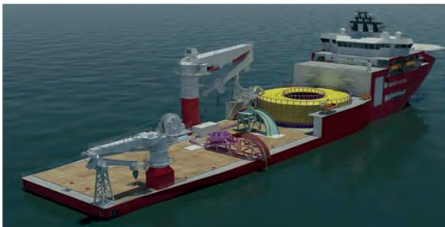
Figur 2.20 Exempel på kabelförläggingsfartyg.
