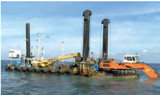
Figur 2.25 Exempel på grävmaskin på en pråm.
