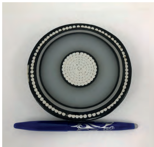
Figur 2.19 Exempel på sjökabel i genomskärning. Under kabeln syns en penna för storleksjämförelse. För Hansa PowerBridge kommer koppar- eller aluminiumledare att nyttjas.
