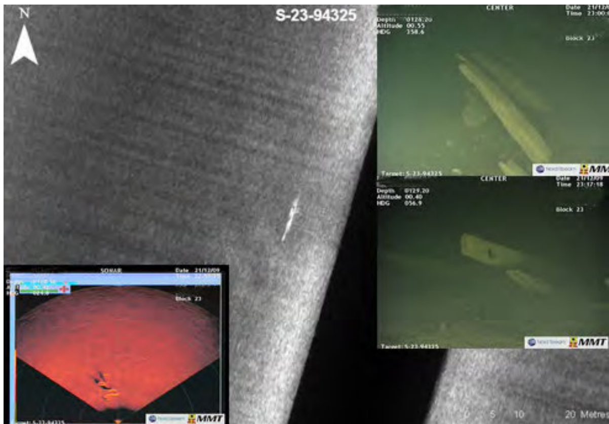
FIGUR 2. Sonarbild och ROV-bilder från en fartygslämning, som påträffades längs med gasledningen Nord Stream i Östersjön (Fredholm 2010:24).
