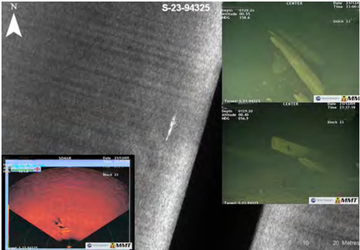
FIGUR 3. Sonarbild, ROV-sonarbild (nedre vänster) och fotografier tagna med en ROV på en fartygslämning, som påträffades längs med gasledningen Nord Stream i Östersjön [REDACTED]
