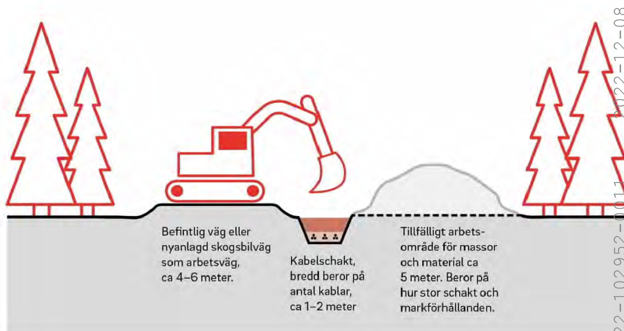
Figur 6. Typfigur för arbete med markkabel. En arbetsväg behövs på ena sidan kabelschaktet och yta för upplag av tillfälliga massor behövs på andra sidan. I aktuellt fall kommer det endast bli ett kabelförband i schaktet.
